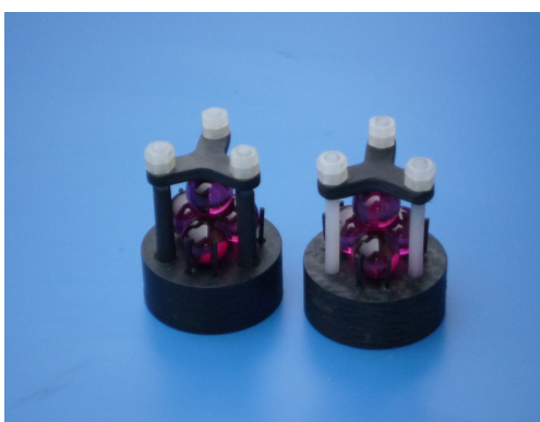
Mini Tetraeder für Tomografie Systeme inkl. Überprüfung der Auflösung
