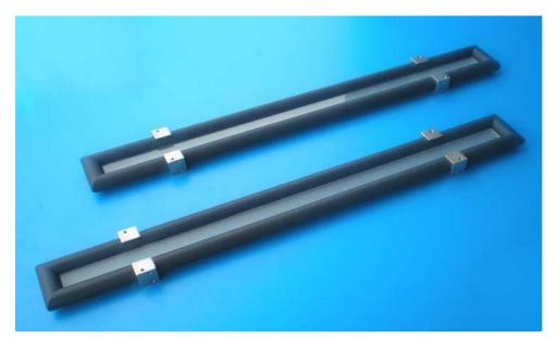
**ESCALON Strichmaßstäbe** (oder "Opto ESCALON") sind Prüfkörper für Video-KMG. Sie sind geeignet für Annahmeprüfungen nach der Norm ISO 10360-7.
